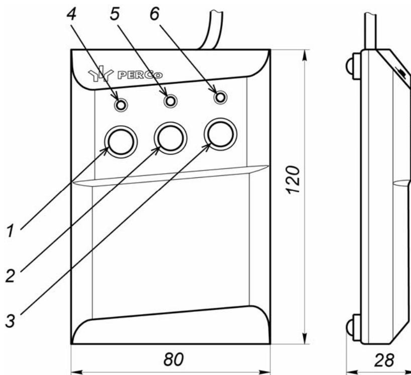
**Рисунок 4. Общий вид и габаритные размеры ПДУ**
