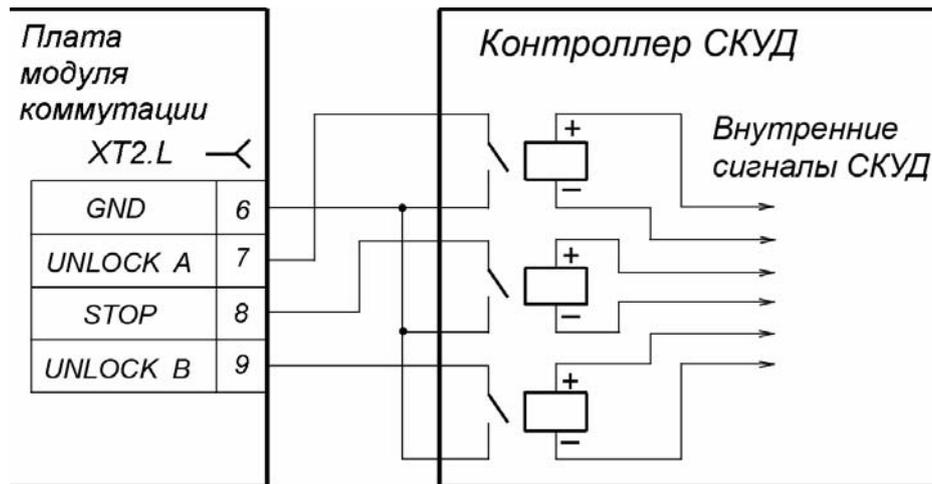
Рисунок 5. Управляющий элемент СКУД – нормально разомкнутый контакт реле
